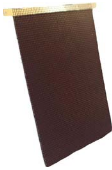
Fig. 3. Gas diffusion electrode (GDE).
